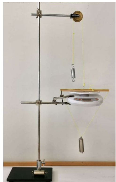
Εικόνα 2: Τροποποιημένη ζυγαριά κουζίνας
